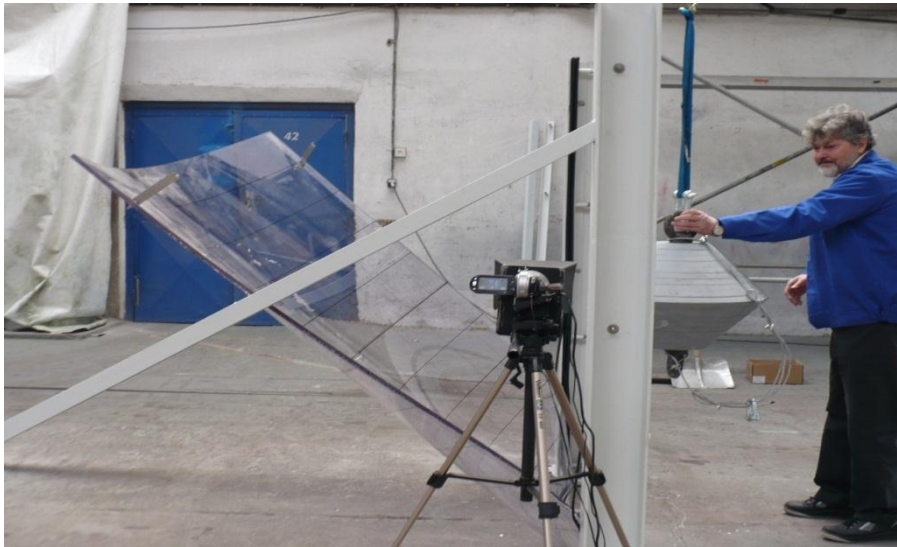
Padající úlomky – rázová zkouška
