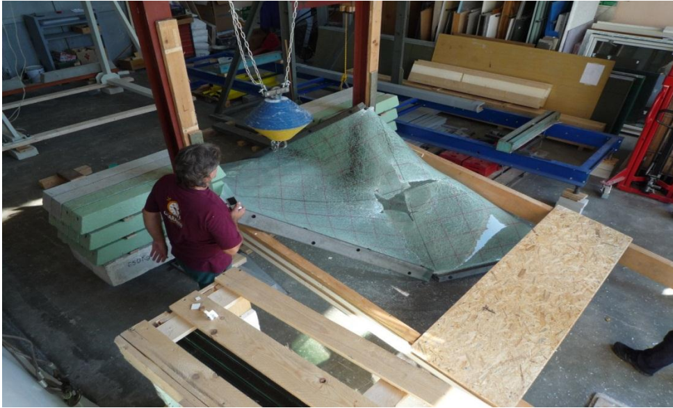
Padající úlomky - rázová zkouška
