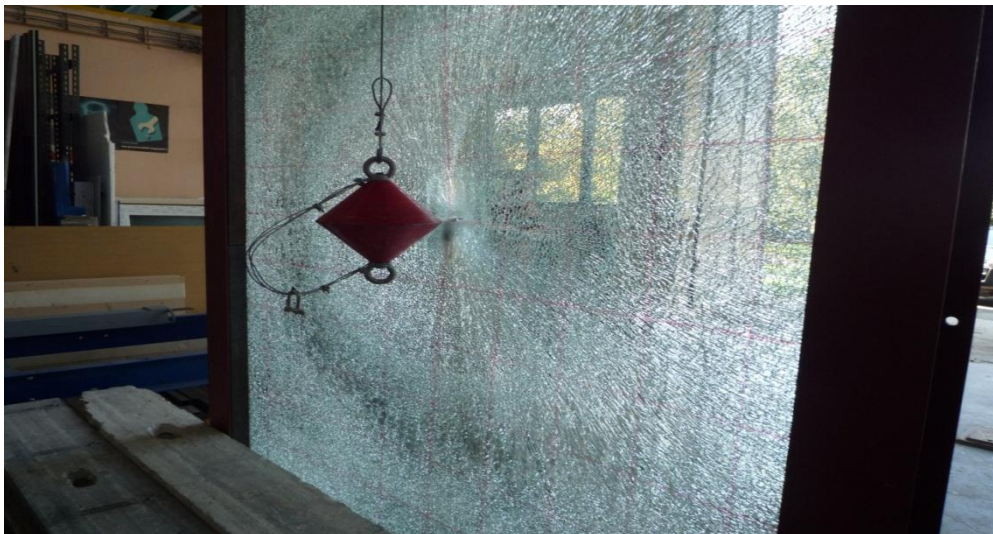
Padající úlomky - rázová zkouška
