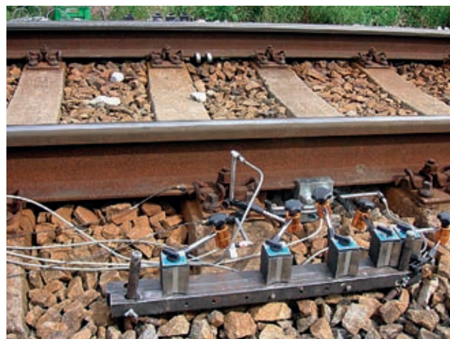
Obr. 4 – Osazení snímačů v koleji; betonový pražec; pohled z měřicího bodu 1
