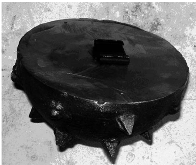
Obr. 4 – Přípravek k fixaci akcelerometru v kolejovém loži – měřící polokoule
