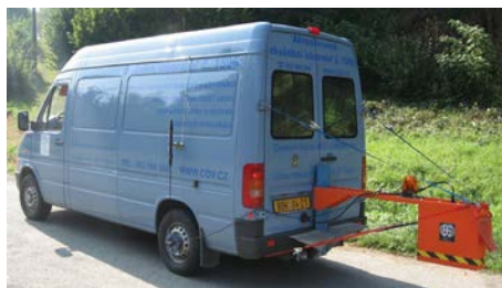
Obr. 7 Příklad zařízení pro měření tlouštěk vrstev vozovky, zdroj: CDV
