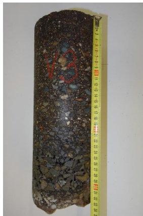
Obr. 6 Jádrový vývrt, zdroj: CDV
