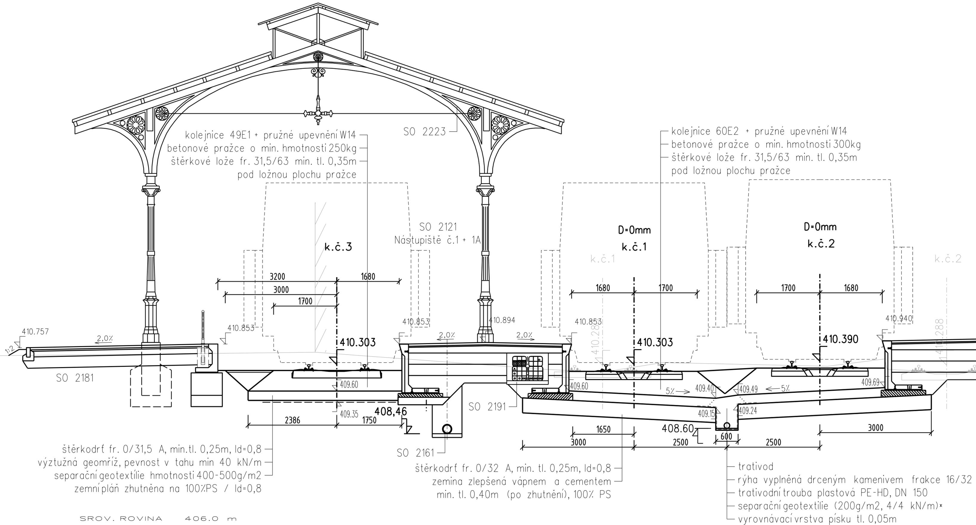
kolejnice 49E1 + pružné upevnění W14
