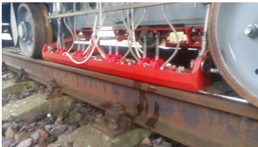
Systém ultrazvukové kontroly kolejnic na měřicím podvozku Ultrasound track inspection system on the measuring chassis
