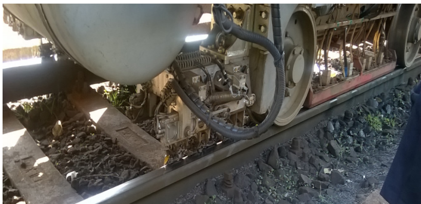
Měřicí systém vířivých proudů Eddy Current Measurement System
