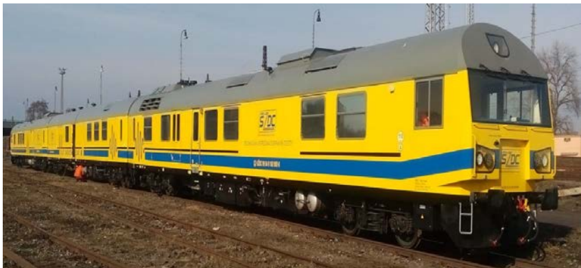
Diagnostická jednotka pro nedestruktivní kontrolu kolejnic Diagnostic unit for non-destructive control of rails
