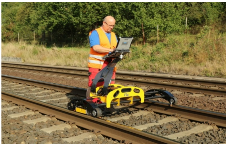
Ruční vozík pro měření systémem ET Hand-held trolley for ET measurement
